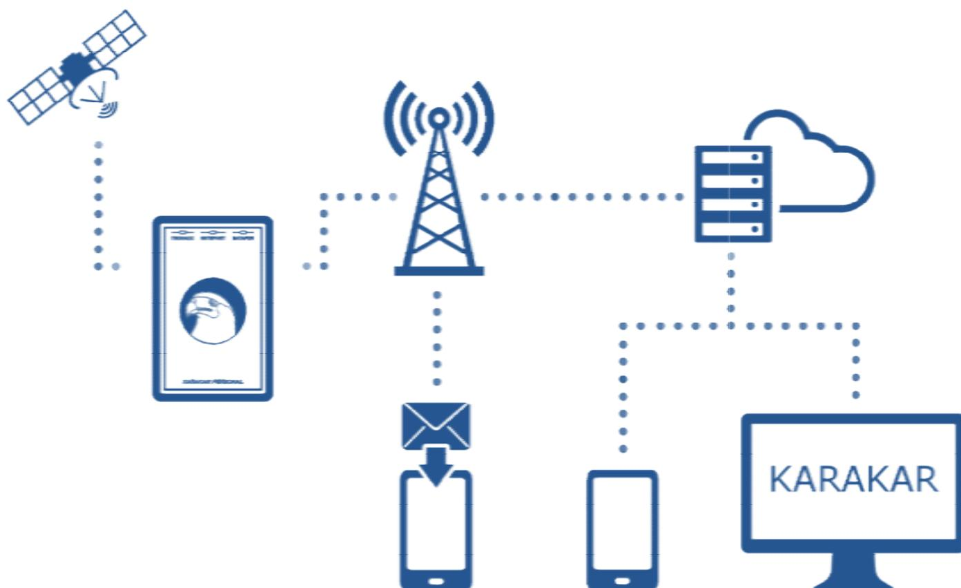
Рисунок 2 – Принцип работы трекера в составе спутниковой системы мониторинга «KARAKAR»
