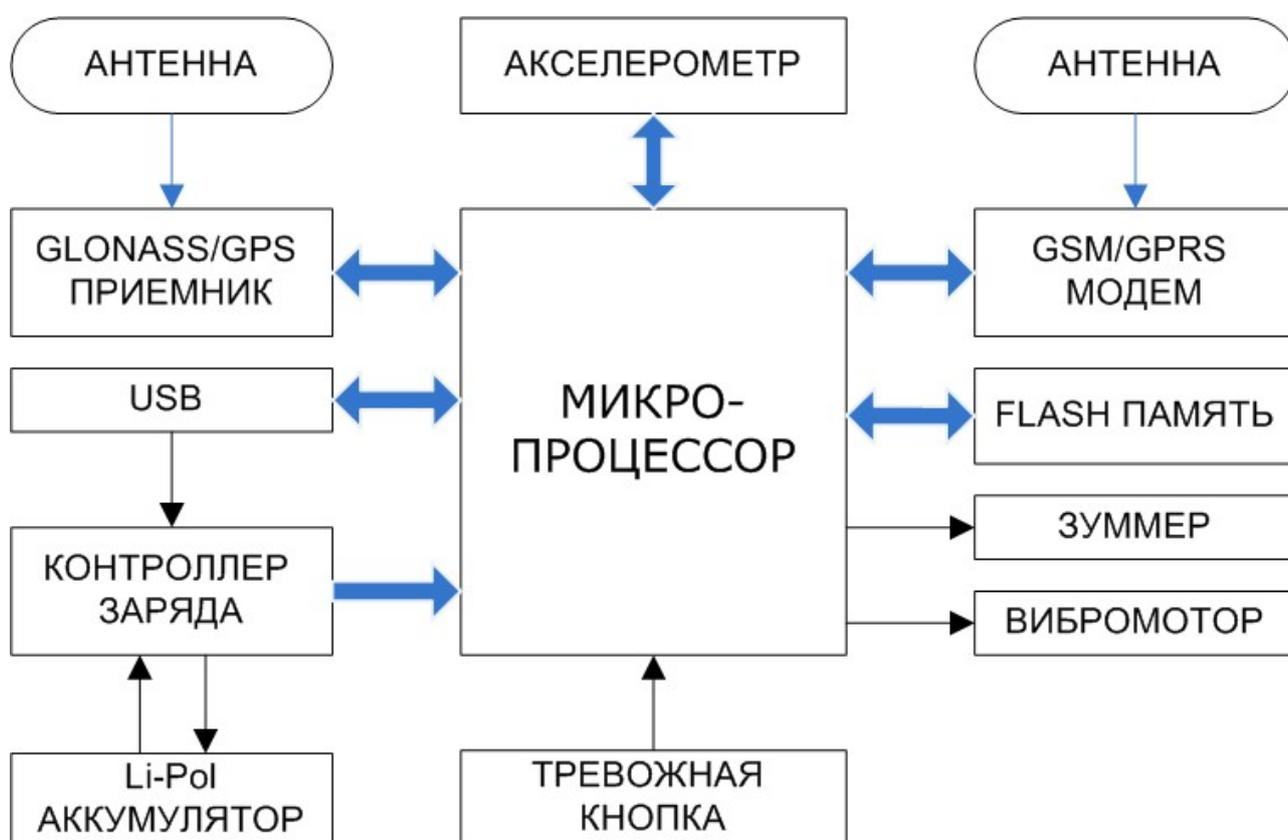
Рисунок 1 – Структурная схема трекера
